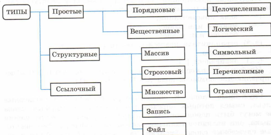
Рис. 2.2. Система типов данных Паскаля
