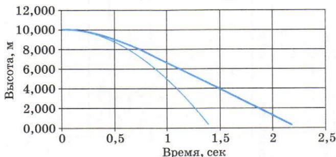
**Рис. 3.8.** Зависимость высоты тела от времени при падении в воде и в воздухе (жирная линия — в воде, тонкая — в воздухе)
