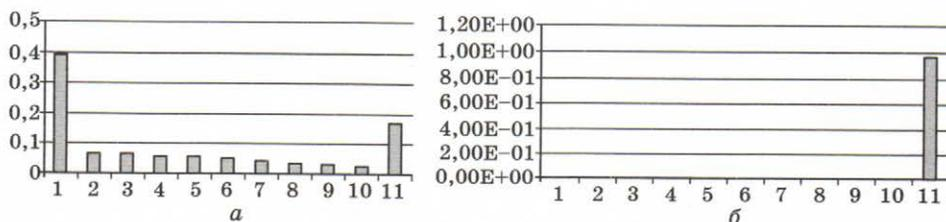
**Рис. 3.63.** Распределение времени ожидания в очереди при: а)  $P = 10$ ,  $Q = 8$ ; б)  $P = 10$ ;  $Q = 10$  (во втором случае все столбики, кроме последнего, в масштабе диаграммы не видны)
