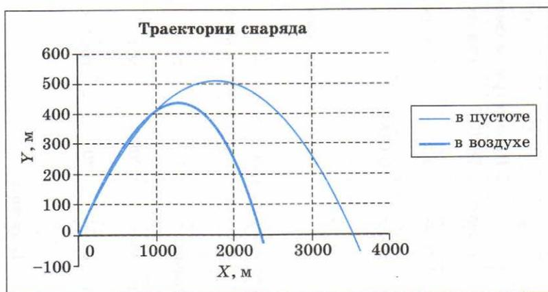
Рис. 3.12. Траектории полета снаряда в пустоте и в воздухе
