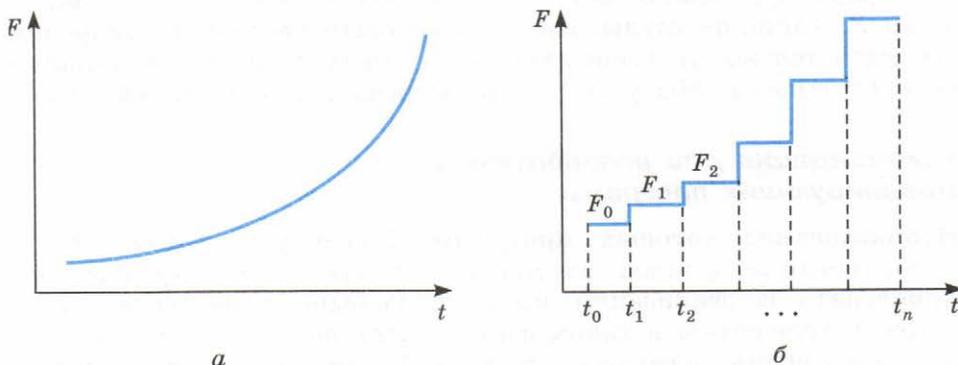
Рис. 3.1. Графики непрерывной (а) и дискретной (б) моделей
