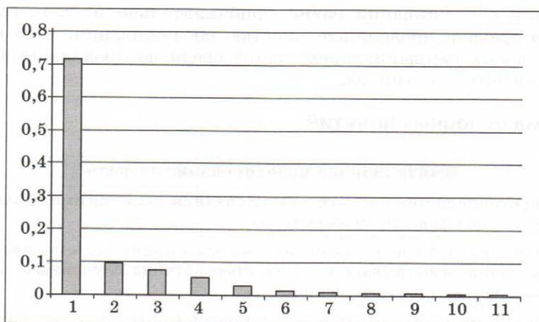
**Рис. 3.62.** Распределение времени ожидания в очереди при  $P = 10$ ,  $Q = 5$
