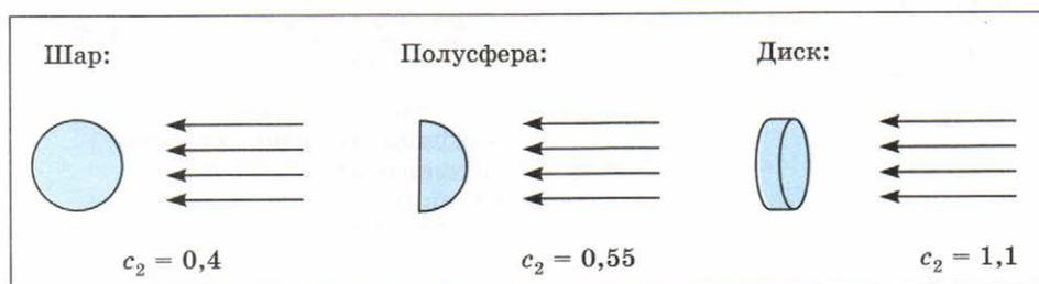
**Рис. 3.6.** Коэффициент лобового сопротивления (стрелки — направление потока обтекающего газа или жидкости)
