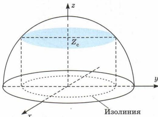
Рис. 3.31. Построение изолинии сферической поверхности
